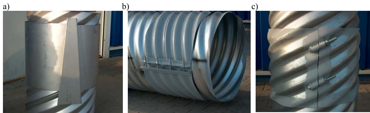
Rys. 2.8 Widok łączników rur spiralnie nawijanych: a) zaciskany klinowo, b) fałdowany i skręcany, c) fałdowany i skręcany śrubami przez tuleję.
